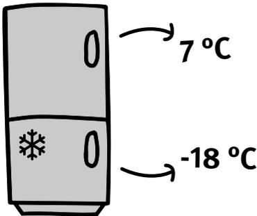
Stellen Sie Ihren Kühlschrank auf eine Temperatur von 7 °C ein (Stufe 2 oder 3). Überprüfen Sie das per Thermometer. Je kälter, desto mehr Strom wird benötigt.
